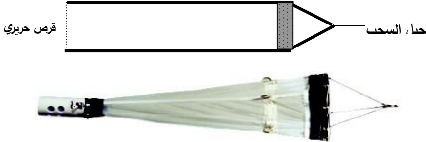
شكل 9: نماذج لأدوات تقدير الهائمات في البيئة المائية
