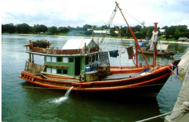
شكل 69: مركب جر صيد تقليدي مصنوع من الأخشاب
